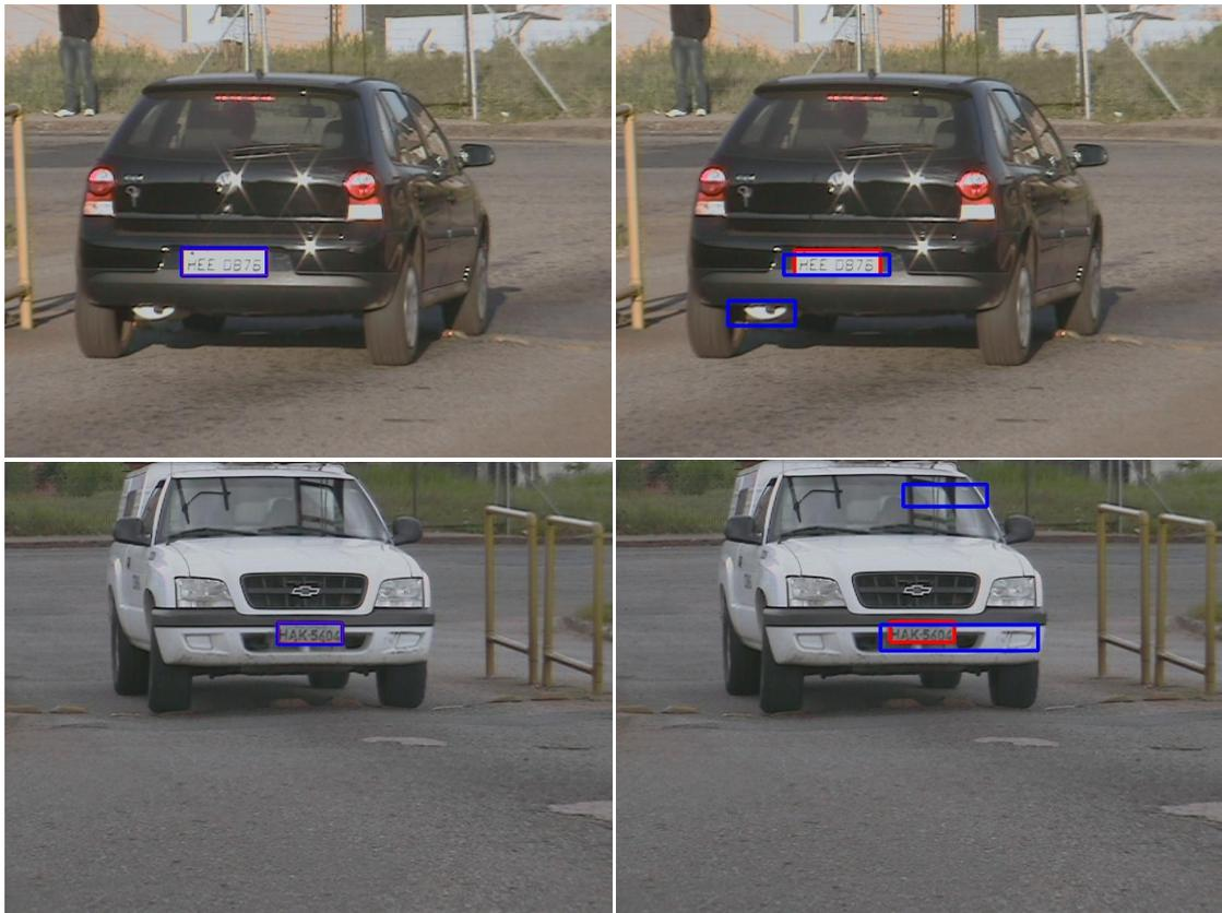
**Figura 5.22:** Exemplos de resultados obtidos com o método adaptativo (esquerda) e o método híbrido (direita). As regiões em vermelha correspondem às rotulações, enquanto que as regiões em azul são as detectadas.
