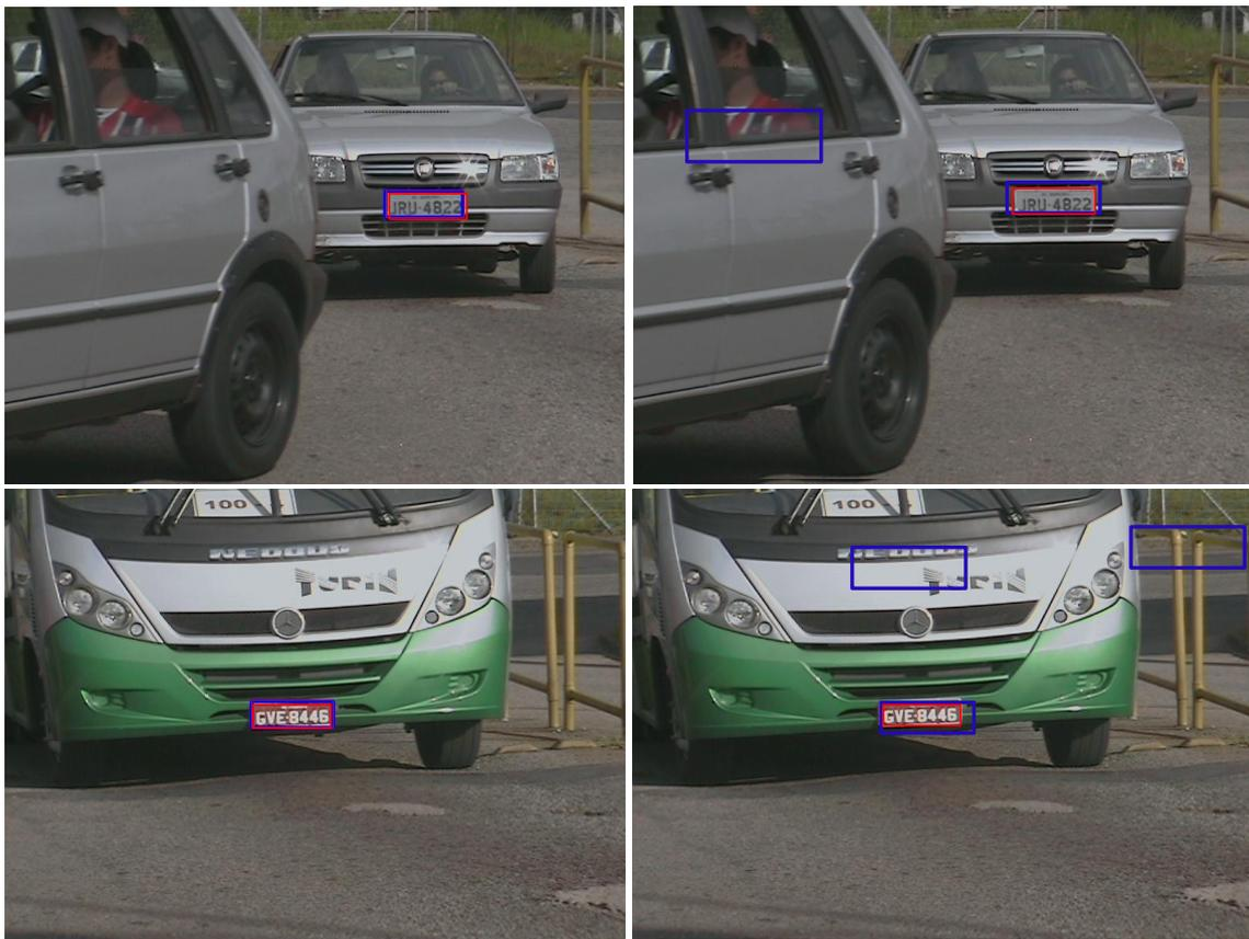
**Figura 5.23:** Exemplos de resultados obtidos com o método adaptativo (esquerda) e o método estático (direita). As regiões em vermelha correspondem às rotulações, enquanto que as regiões em azul são as detectadas.
